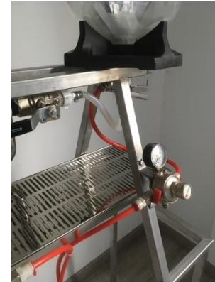
Manomètre de réglage de la contrepression pour maîtriser la force et le débit de remplissage
